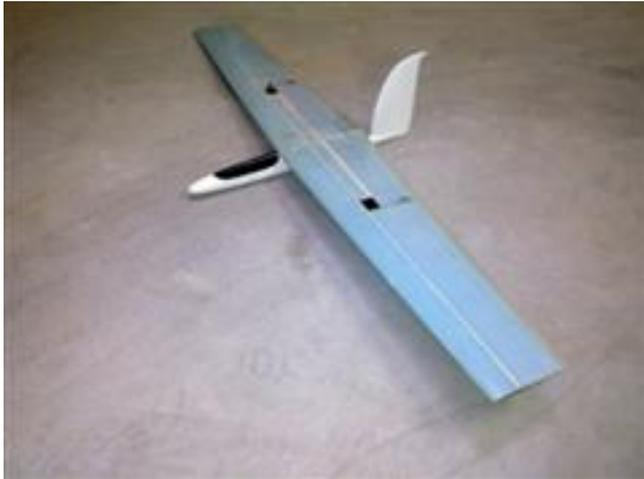
El Proto DS es un minivelero de ladera de 1500mm para vuelo rápido de gran rendimiento y penetración en días de vientos medios a fuertes, construido enteramente en fibra, aunque también admite otras posibilidades de construcción.
